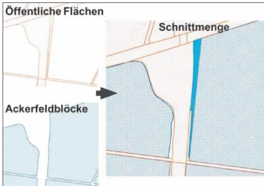
Abb. 4: Automatische Verschneidung der Daten-Layer „Öffentliche Flächen“ und „Ackerfeldblöcke“ zeigt als Schnittmenge die Flächen auf, wo möglicherweise öffentliche Flächen privat genutzt werden Grafik: M. Kneisz/Kreis Soest
